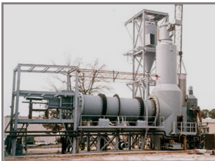
Mynd 5 - Sorporkusamstæða með veltiofn og lóðréttan eftirbrennsluhvarfa
